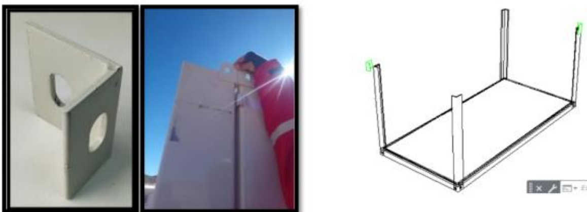
Imagen 1- Perfil ángulo/ Colocación en columnas
