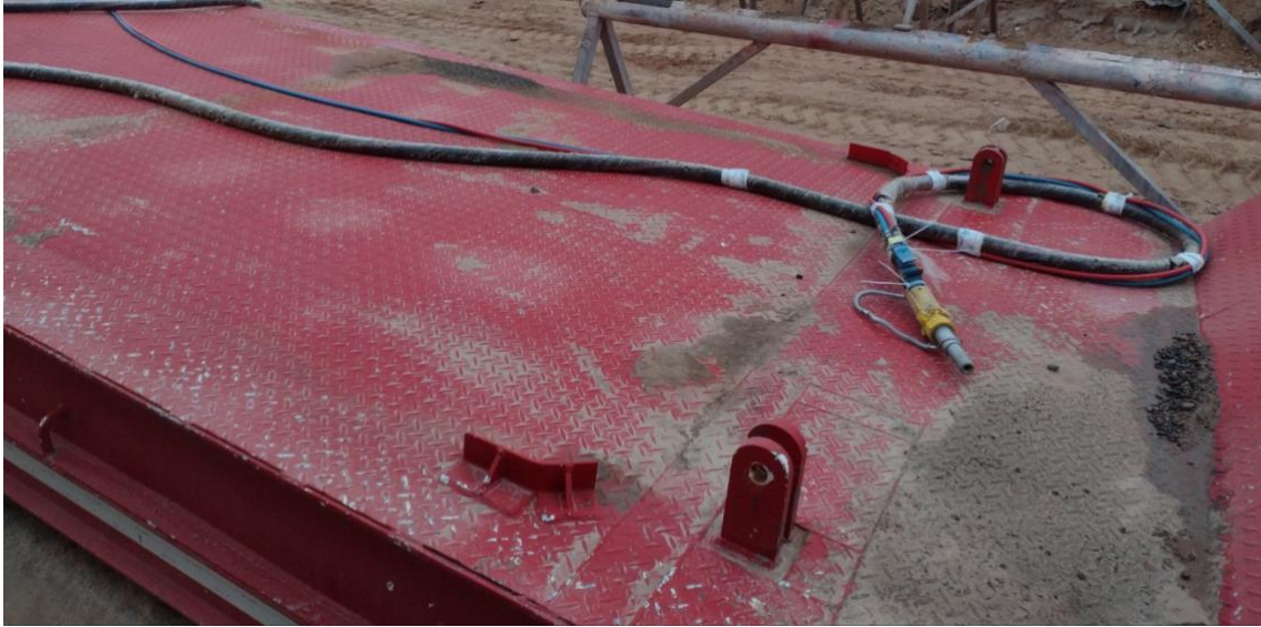
Imag.4 (Manguera de arenado utilizada en la empresa)
