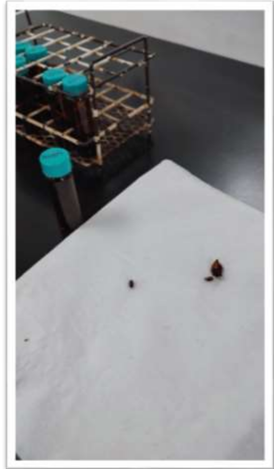
Ilustración 24 - Restos de vidrio de vial roto
