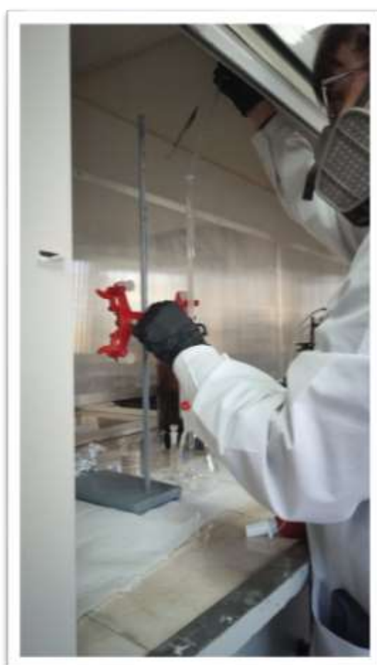
Ilustración 20 - Columna de separación utilizada en cabina
