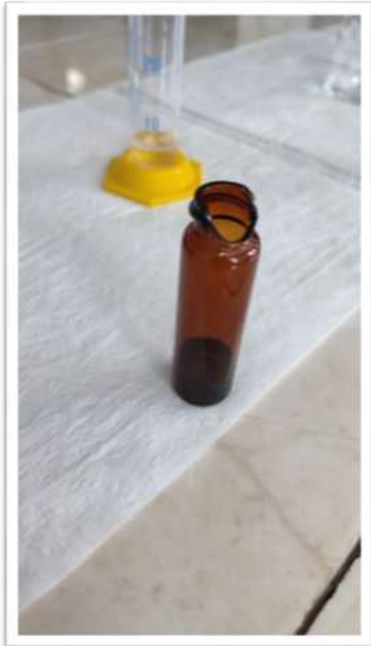
Ilustración 23 - Vial roto producto de la reutilización
