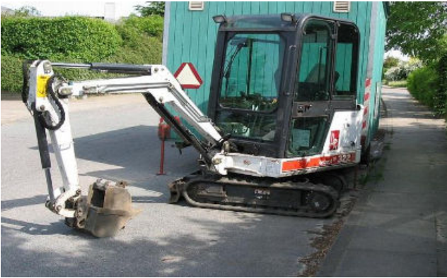
Bobcat equipado con pala retroexcavadora montada sobre oruga.
