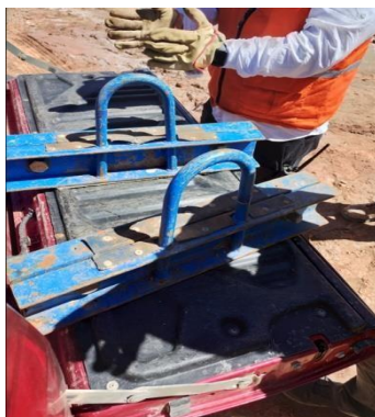
Elevadores de tramos de manga
