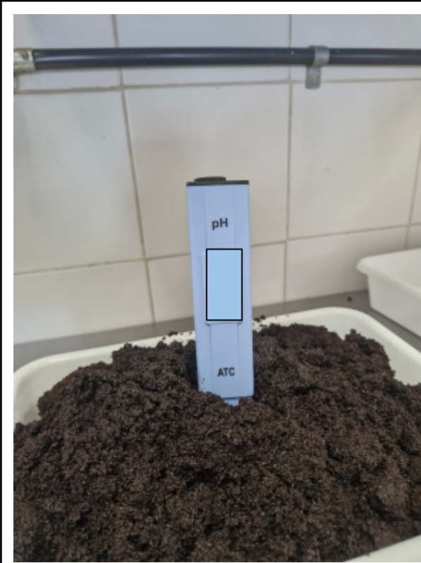
Control de pH en borra de café luego del proceso de pasteurización
