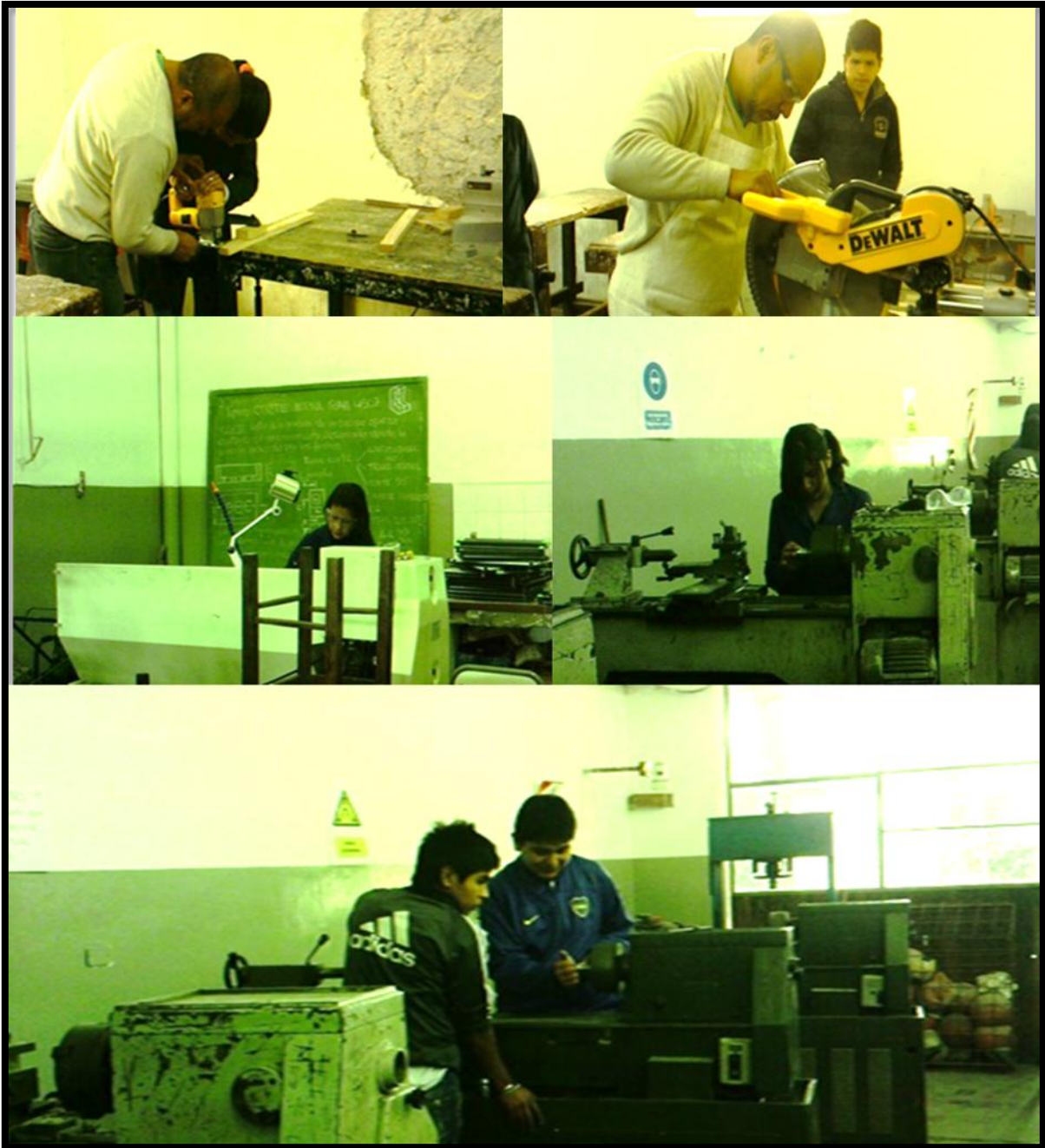
Foto nº 23: Falta de Elementos de protección personal
