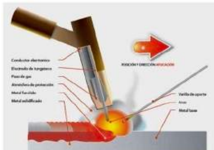
Imagen 6. Proceso GTAW. Fuente. Lincoln Electric
