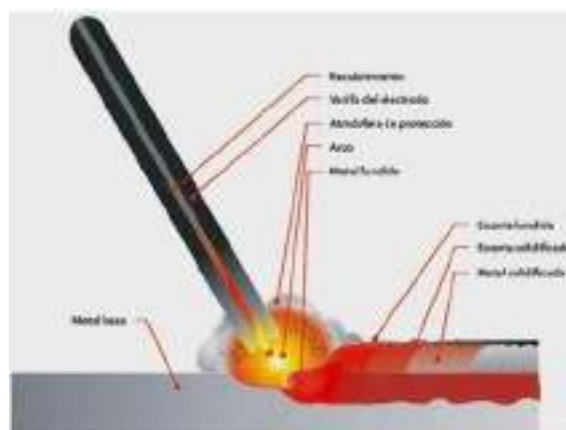
Imagen 4. Proceso SMAW. Fuente. Lincoln Electric
