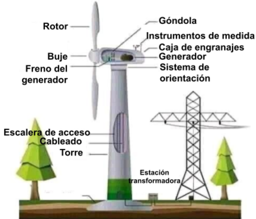
Figura IV. Esquema de un aerogenerador y sus componentes.
