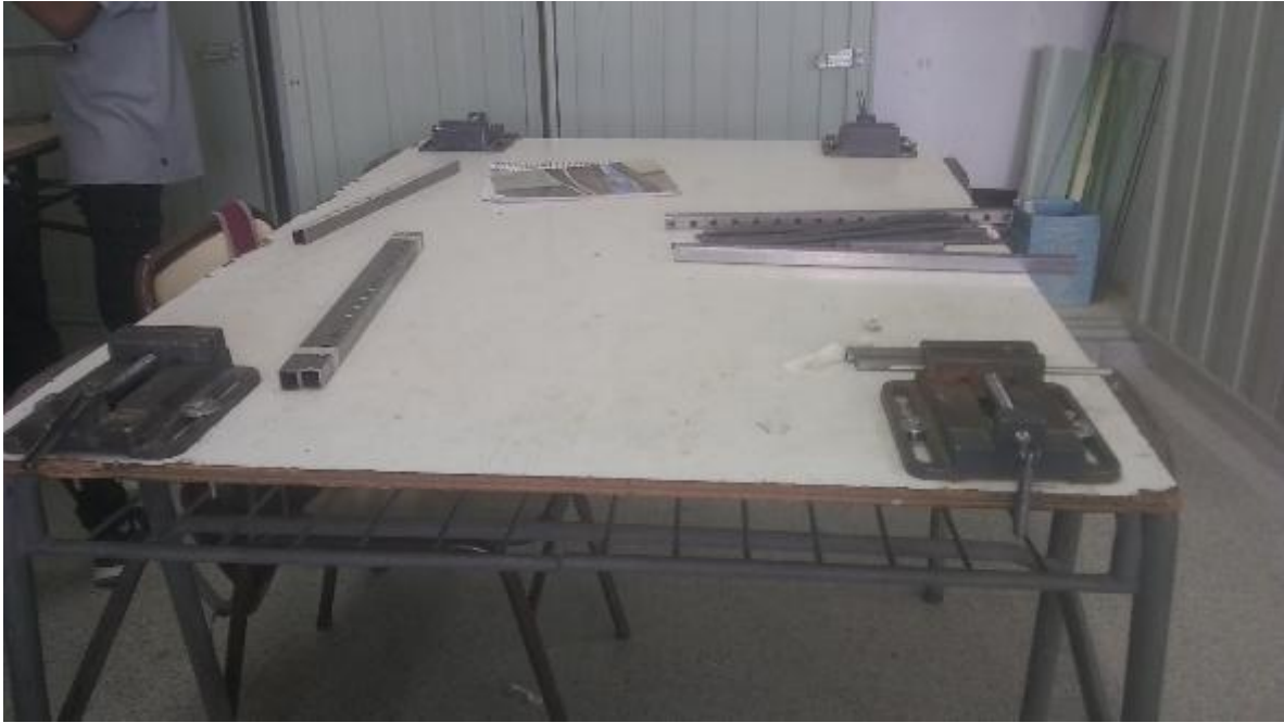
Foto N° 3: Banco de trabajo adaptado, donde se realiza el armado de las parrillas, una vez acondicionadas las piezas.
