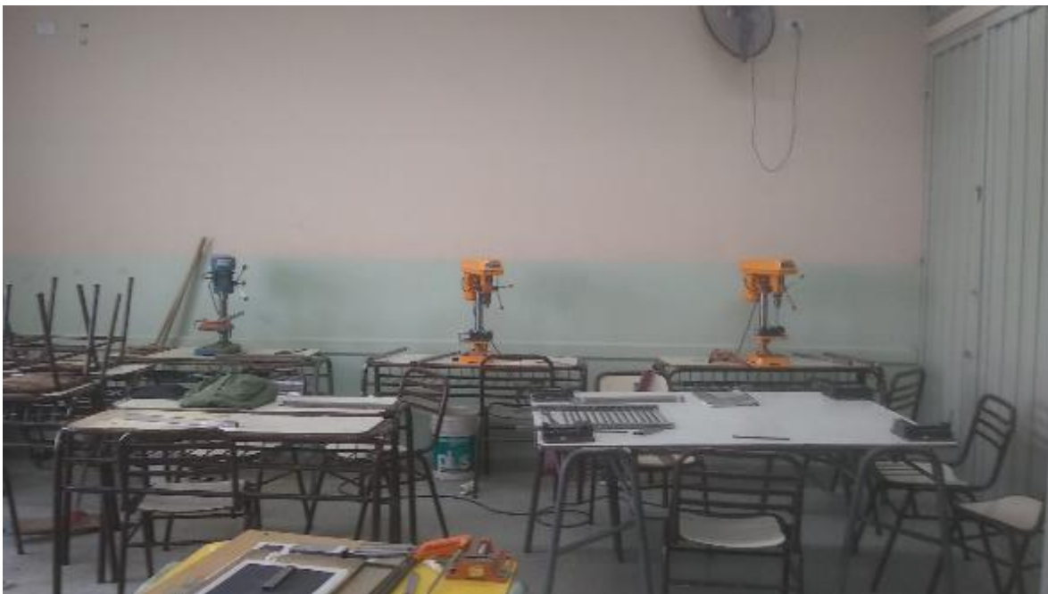
Foto N° 1: Taladros de banco: GardenplusGP TB -13C) x 1 - Lusqtoff TB -13 x 2, ubicados al fondo del taller.
