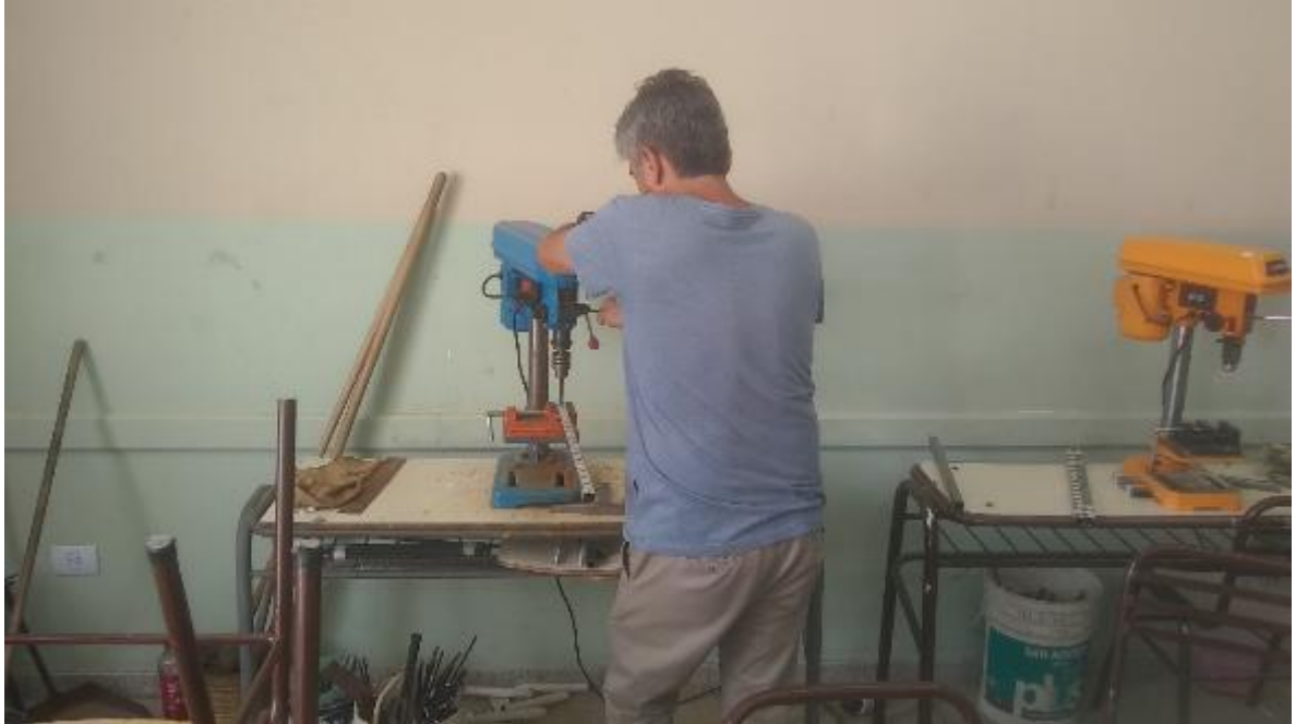
Foto N°7: Profesor efectuando perforaciones sobre las estructuras laterales de la parrilla.
