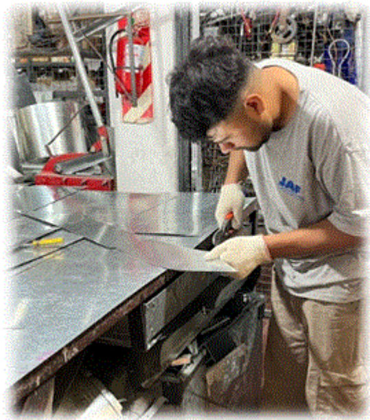
Figuras de trabajo en chapa galvanizada y uso de maquina en JAF
