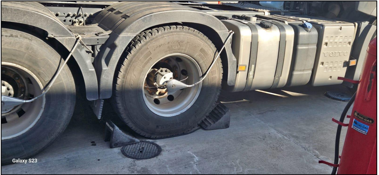
Ubicación de calzos
