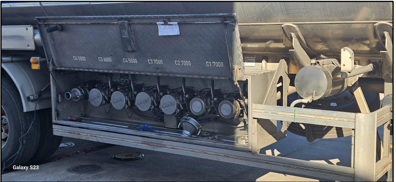
Bocas de descarga
