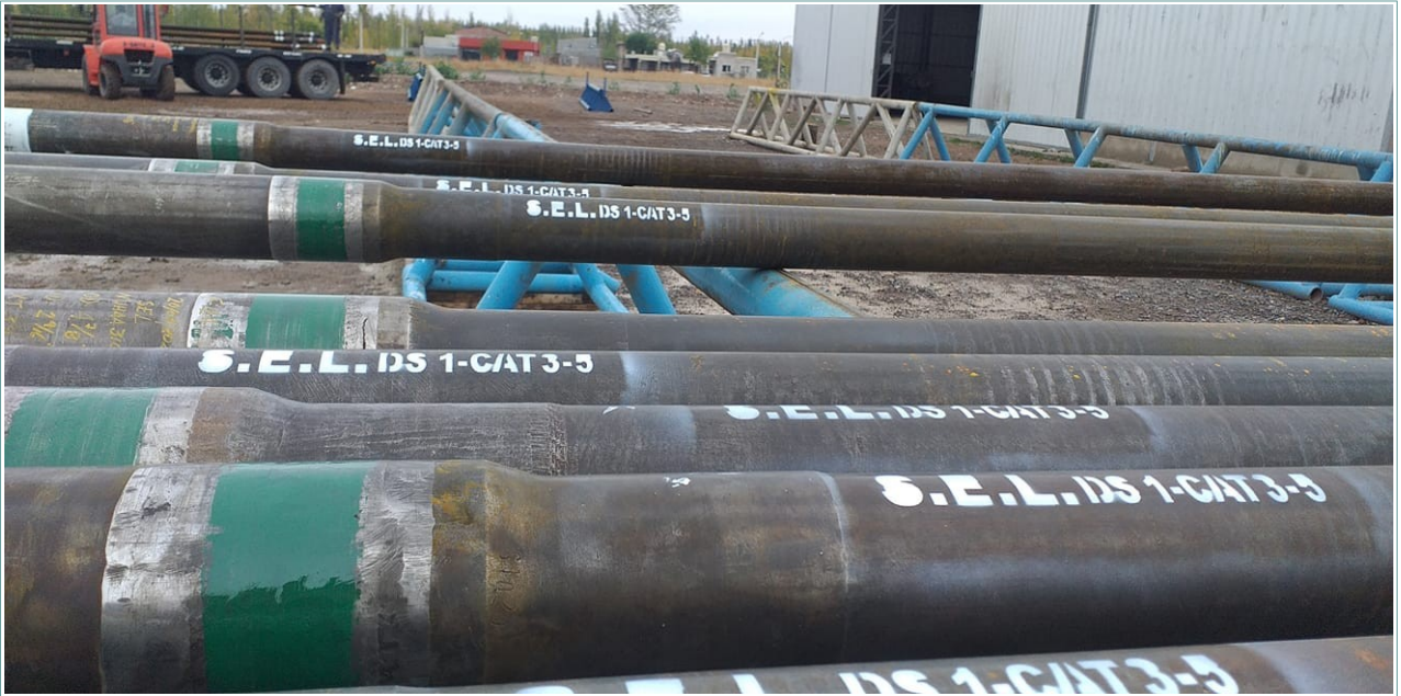
DRILL PIPE INSPECCIONADOS
