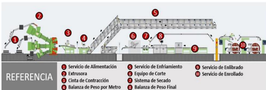
Imagen N°8. Componentes de la línea de extrusión.
