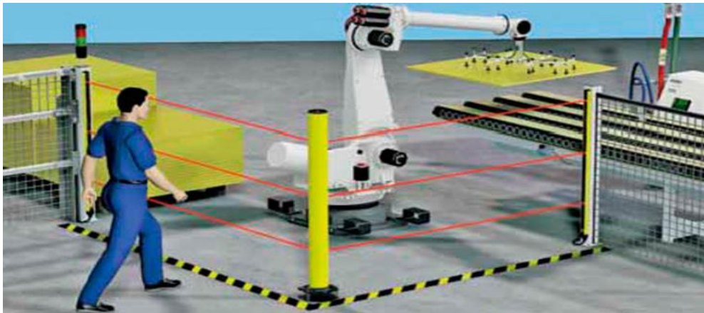
Imagen N°19 Barreras de Seguridad
