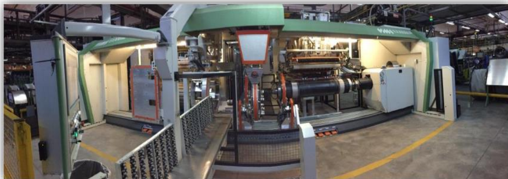
Imagen N°13. Armadora de una etapa
