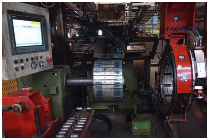
Imagen N°34: Conformado de cintura
