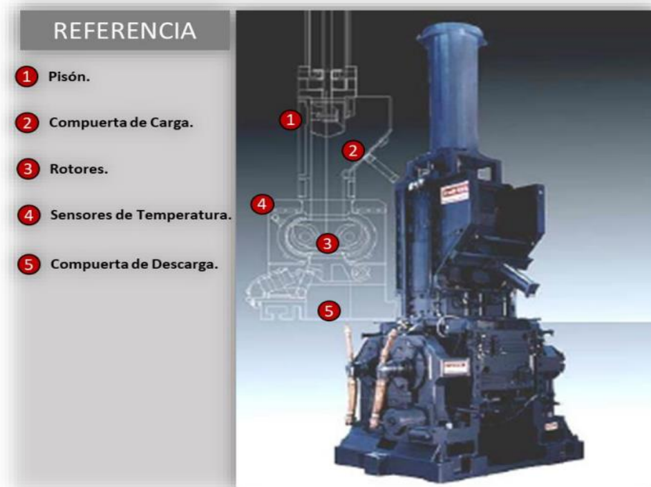
Imagen N° 5: Principales componentes de un mezclador (Banbury).
