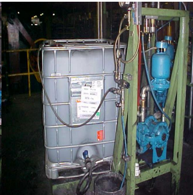
Sistemas neumáticos proveedores de pintura interior y exterior de base solvente a pistolas automáticas.
