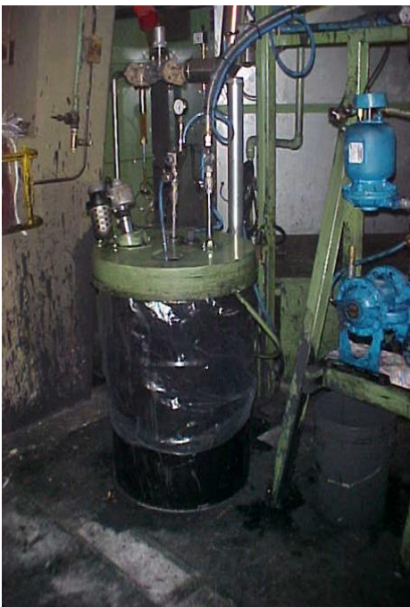
Sistemas neumáticos proveedores de pintura interior y exterior de base solvente a pistolas automáticas.
