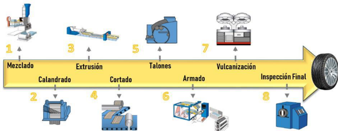
Imagen N° 4: Esquema de proceso
