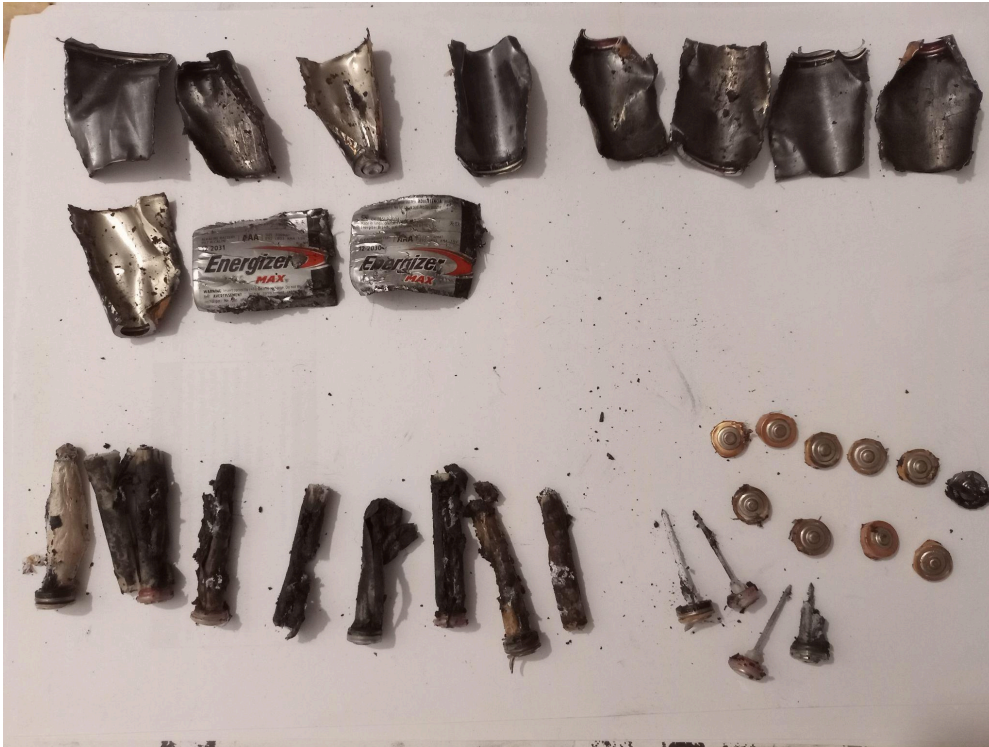
Figura N°13. Partes obtenidas al desarmar pilas alcalinas. Arriba: carcasas. Abajo: separadores de papel, colectores y contactos positivos (partes de las carcasas).
