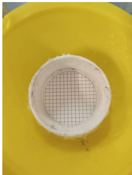
Figura N°22. Filtro de membrana de 0,45\ \mu\text{m} colocado en el embudo previo a la filtración.
