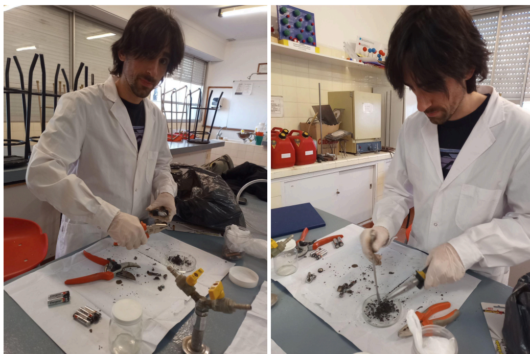
Figura N°20. Desmantelamiento de las pilas.
