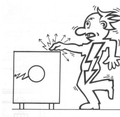
Imagen 4.9 contacto eléctrico indirecto
